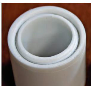
Вид отторцованной трубы PP-ALUX
